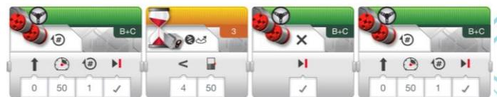
7. 插入 Medium Motor 選擇「On for Degrees」及設定馬達轉動方向和角度，指示機械人卸下貨物。
