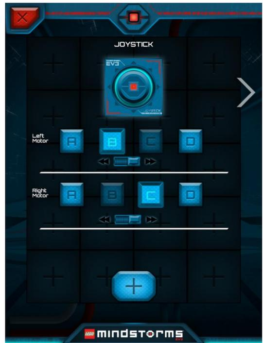
4. 完成配置後，按右下角按鍵確定遙控按鍵設置完成，可直接遙控 EV3 機械人
