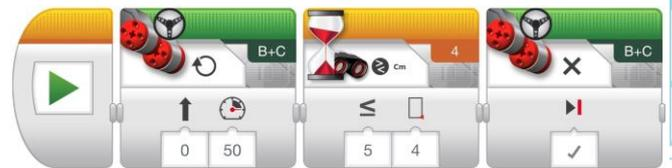
7. 插入 **Medium Motor** 選擇「**On for Degrees**」及設定馬達轉動方向和角度，指示機械人提取「障礙物」。
