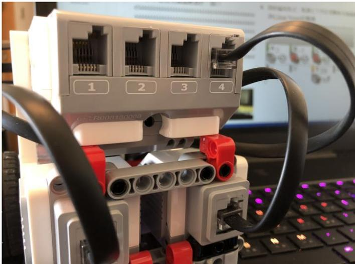
2. 開始編寫程式，點選右下角位置觀察「插口 4」的超聲波感應器(Ultrasonic Sensor)的數據。
